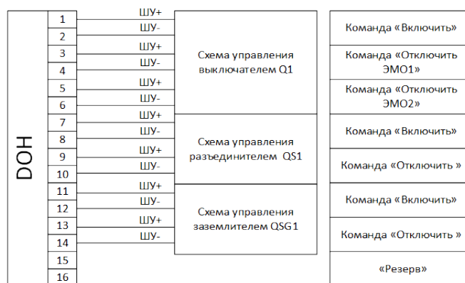
Рисунок 14 – Схема подключения модуля в режиме «Телеуправление» DOTC
