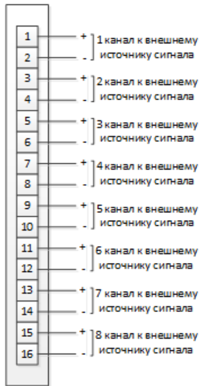
Рисунок 16 – Схема подключения внешних устройств к модулю AI24C.6
