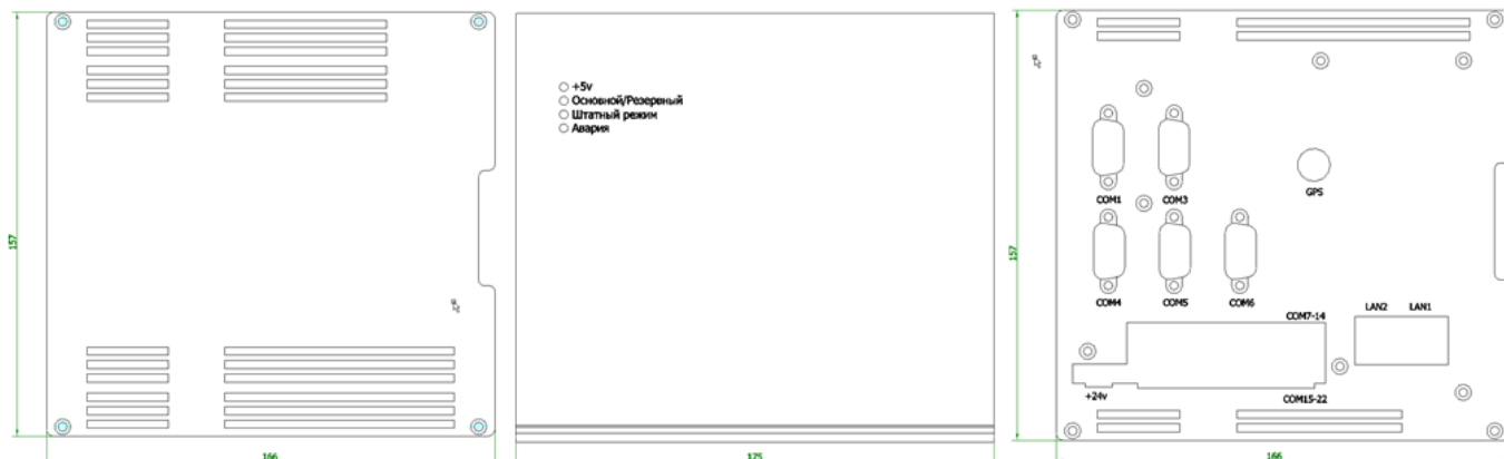
Рисунок 1 – Разъемы и светодиодные индикаторы ARIS MT200
