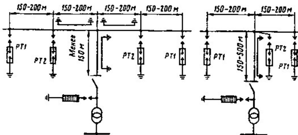
Рис. 16. Схемы защиты от грозových перенапряжений подстанций, присоединенных к ВЛ ответвлениями длиной до 150 м и более 150 м
