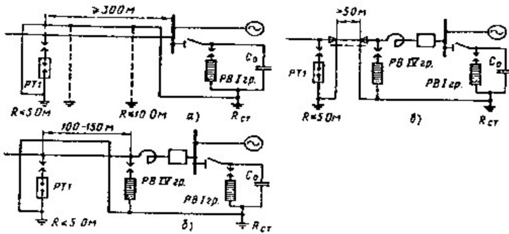
Рис. 18. Схемы защиты вращающихся машин от грозových перенапряжений
