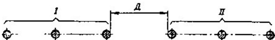
Рис. 7. Наименьшие расстояния по горизонтали между токоведущими частями разных цепей с обслуживанием одной цепи при неотключенной другой
